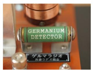
あとは端子です。カラフルな端子は似合いません。ベーク板には無骨な金属製の端子が一番似合います。ローレットナット・6 角ナット・ねじを駆使して端子を復元しました。また、ゴム足を留めているナットも六角から袋型に取替え、正真正銘の魅せるラジオが完成しました。(写真 16・17)
