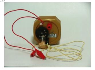
文献等によると、大昔の鉱石ラジオは同調回路にコンデンサは無くコイルのタップ切り替えだけで同調が可能であったそうです。巻いただけで放置してあったコイルにアンテナ・アースを接続し適当なタップを選択してみたところ、放送を聞くことができました。板の上にコイルを固定し簡易的なパネルをつけ、これでも立派なラジオです。(写真 6)
